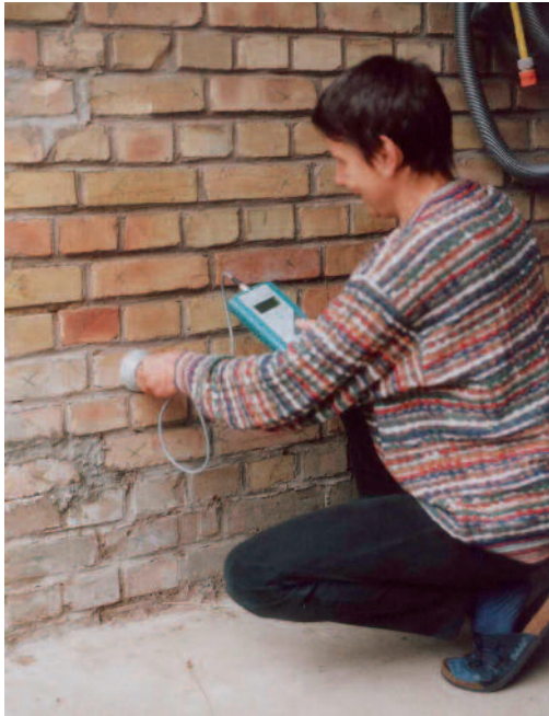
4 Messung der Mauerwerksfeuchtigkeit mittels Mikrowellen.
