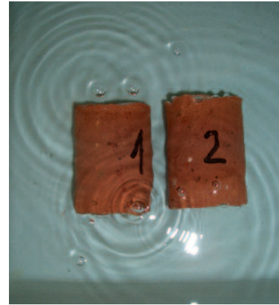
6 Erstellen der Feuchtebilanz: Tränken der Bohrkerns zur Bestimmung der maximalen Wasseraufnahme.
