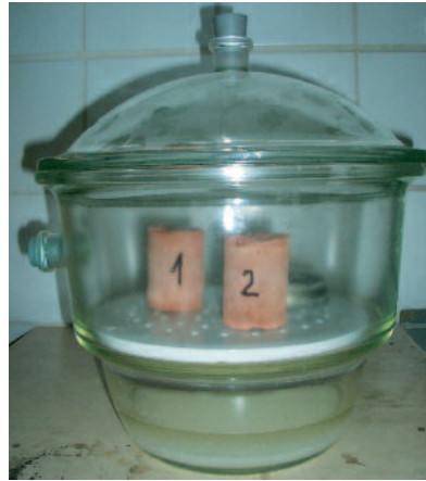
5 Erstellen der Feuchtebilanz: Lagern der Bohrkerns bei hoher Luftfeuchtigkeit zur Bestimmung der Ausgleichsfeuchte.
